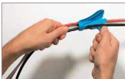
Kabelbündel seitlich in das Aufziehwerkzeug legen.
