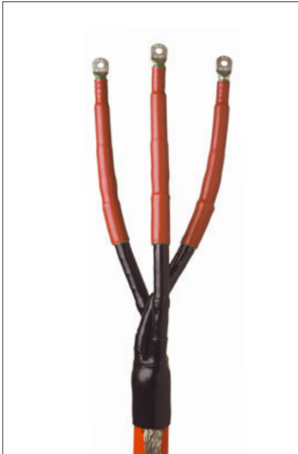
Innenraum-Endverschluss IXSU-F für bandgeschirmte Kabel mit lötfreier Erdanschlussgarnitur und ausgekreuzten Adern. Kurzschlussanzeiger-Montage auf leitfähigen, schwarzen Aderschutzhäuten möglich.
